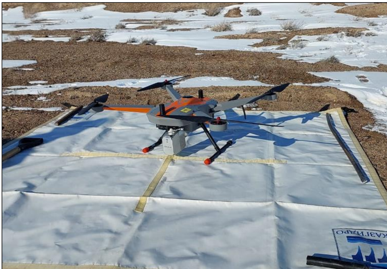
Рисунок 3 – Используемый беспилотный летательный аппарат для выполнения лазерного сканирования территории
