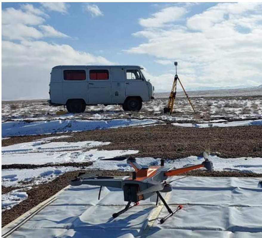
Рисунок 2 – Используемый беспилотный летательный аппарат для выполнения лазерного сканирования территории
